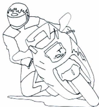
Рис. 7.4. Аналогично верхней и нижней части тела лыжника, мотоциклист наклоняется меньше, чем мотоцикл.
