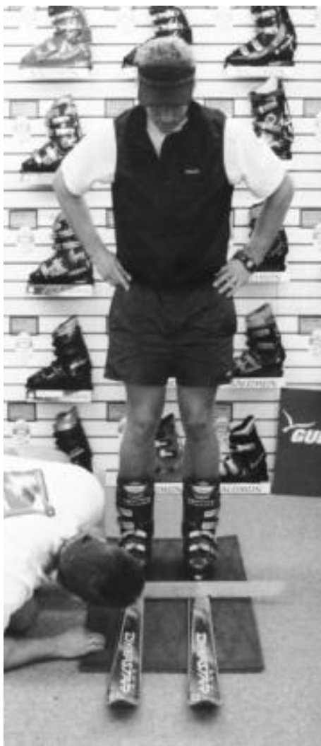
Рис. 13.4. Техник использует метод просвета для проверки выравнивания.
