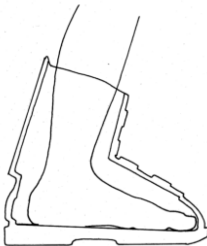
Рис. 11.2. В то время как большой палец упирается в центр носка ботинка, зазор между пяткой и пластиком должен составлять 12-18 мм
