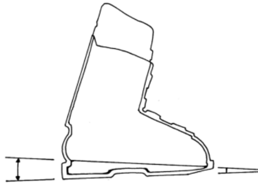
Рис. 11.4. Угол наклона подошвы – это угол между внутренней и внешней стороной подошвы ботинка.
